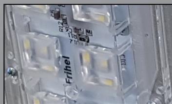
Placa LED FRIHEL, modelo FL4125m intercambiable, de 30W, con fuente de 220V incorporada.
